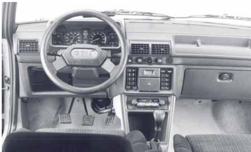
Das GTI-Armaturenbrett unterschied sich von jenem schwächerer 205 hauptsächlich durch das Lenkrad. Viele wurden dennoch gegen belderte Sportversionen getauscht.
